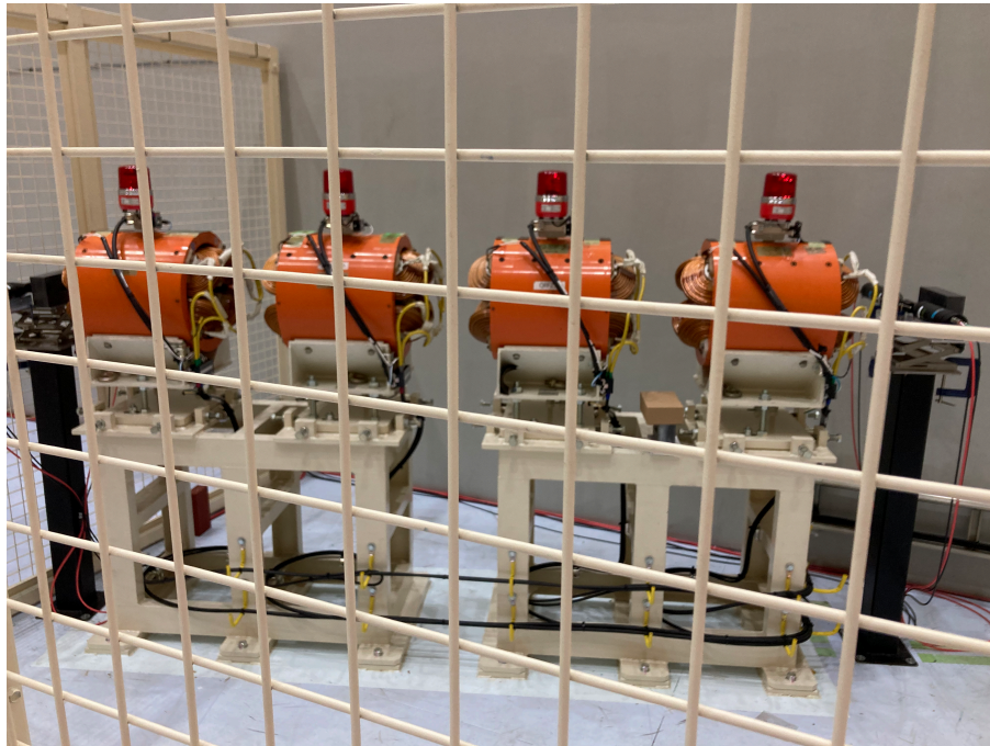
図35: 4つ並べられた四重極磁石。図右側がビームの上流。左右にPMTが設置されている。
