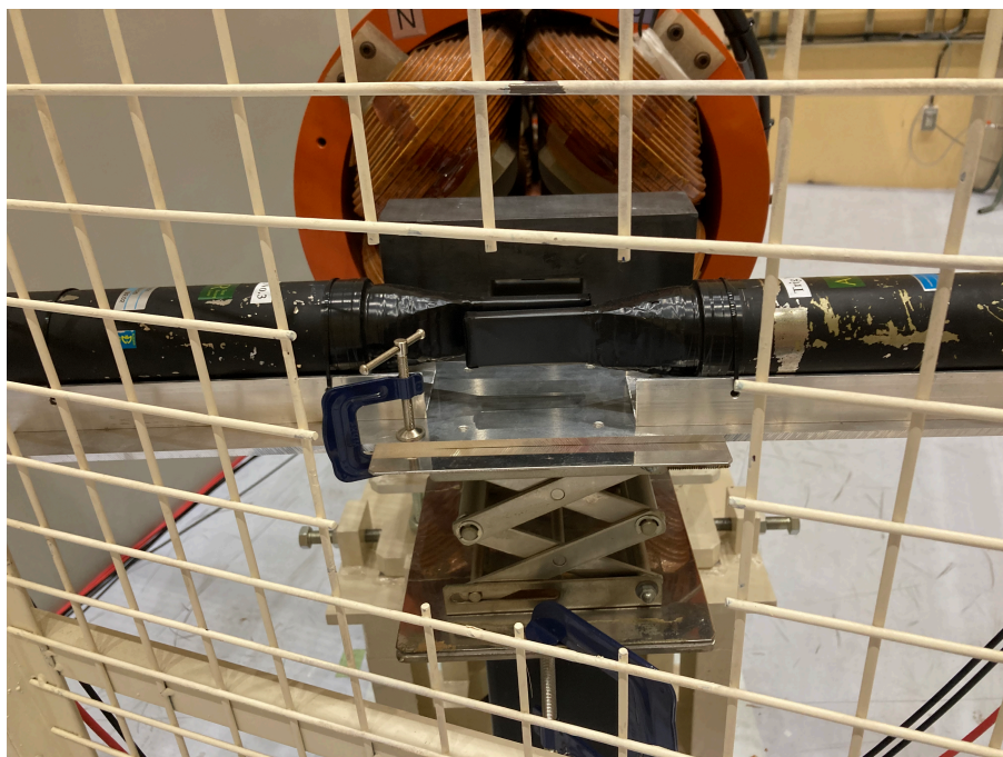
図36: 四重極磁石の下流側のプラスチックシンチレータとPMT
