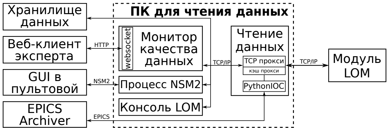
Рис. 8: Схема устройства и взаимодействия со считывающим ПО.
