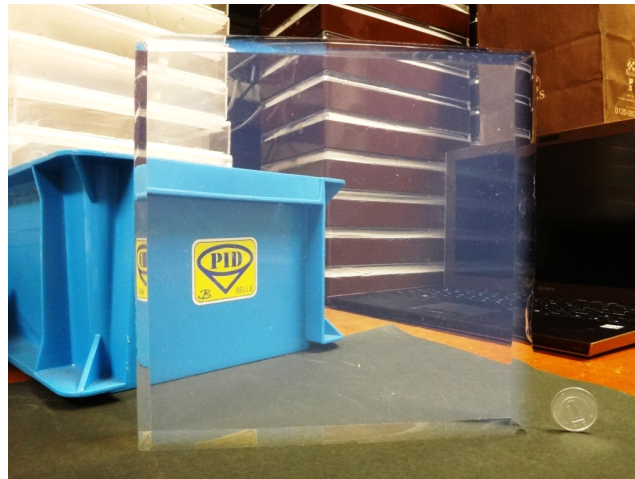
図 3.9: Pin-drying 製法により作成したシリカエアロゲル。 16.8 \times 16.8 \times 2 \text{ cm}^3 クラックフリーのシリカエアロゲルの作成に成功した。
