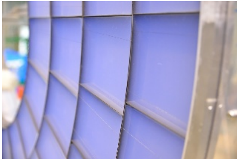
図 3.2.2: ARICH に取り付けられたエアロゲル
