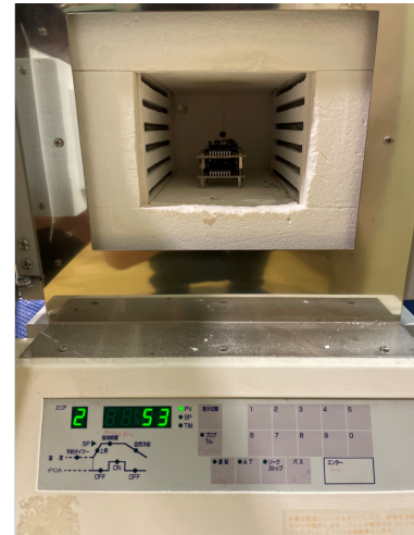
図 7.2.1: 左：電気炉の外観 中：MPPC を並べた様子 右：電気炉内に MPPC を設置した様子
