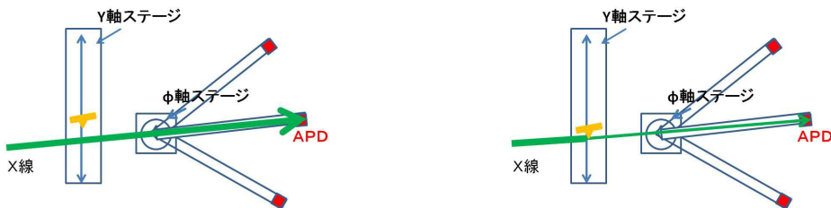
図 28: タンタル片が X 線に当たっていない時の \theta 角を動かした様子 図 29: タンタル片が X 線に当たり始めた時の \theta 角を動かした様子
