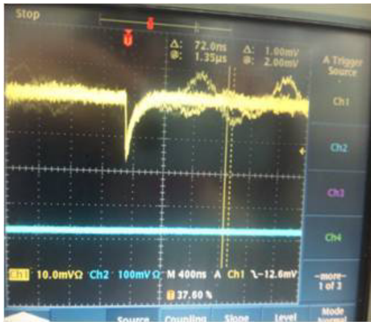
図 47: 鉄線源 (5.9keV) を置いたときのオシロスコープの様子
