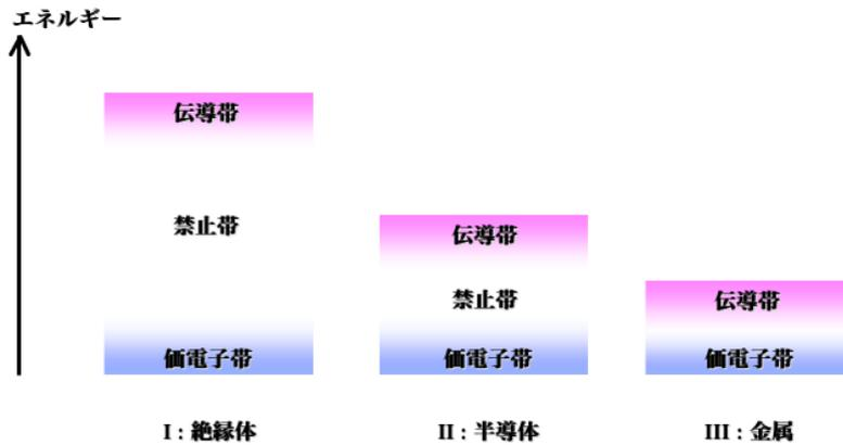
図 4.1 固体中の電子のバンド図モデル
