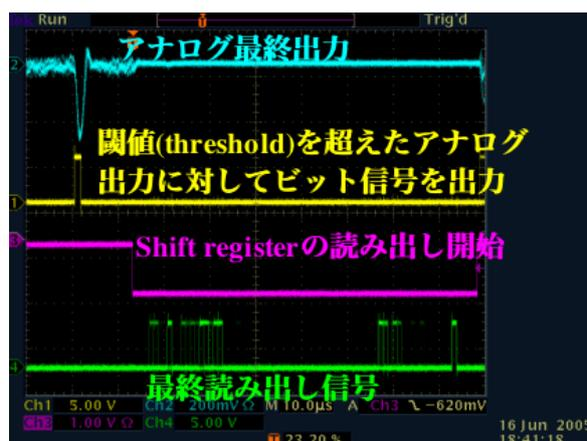
図 5.4 digital part での信号処理
