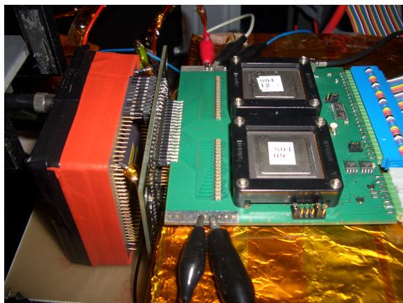
図 6.3 HAPD+ASIC 測定 set-up (写真)
