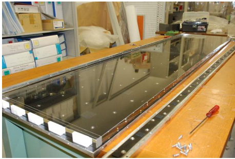
図 2.11: TOP 用光学輻射体クォーツ
