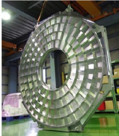
図 3.8: アルミニウム製円形支持体と Aerogel
