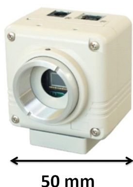
(a) CCD カメラ (STC-TC202USB-AT)
