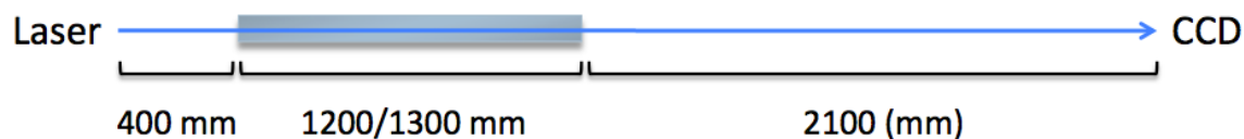
図 3.11: 光路のずれ測定のセットアップ。石英輻射体の端面からレーザーを入射し、反対側の端面から出てくるレーザー光を CCD カメラで測定する。可動ステージに取り付けたレーザーと CCD カメラを同時に動かしてスキャンする。
